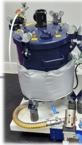
TANQUE DE ACERO DE 30 LITROS CON MANTA CALEFACTADA
